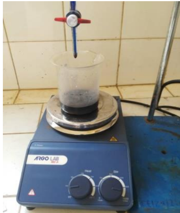
Fig. 4. Méthylène bleue test apparatus.
